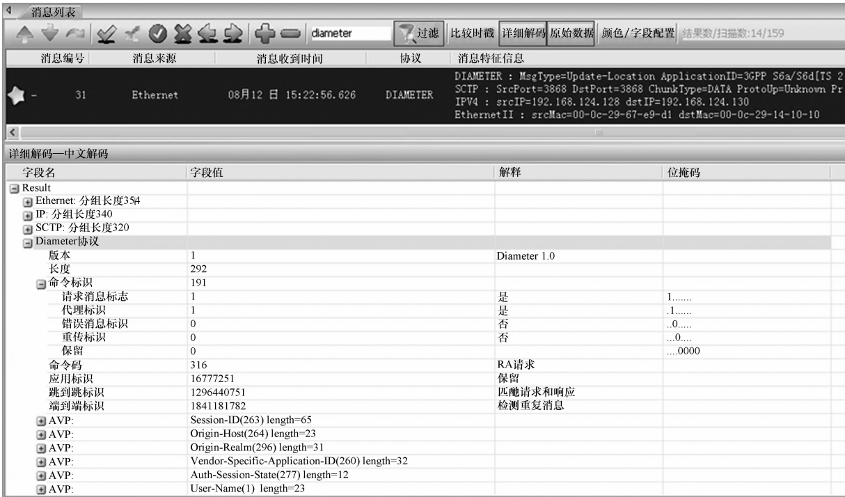
图 5 Diameter 协议解码结果
